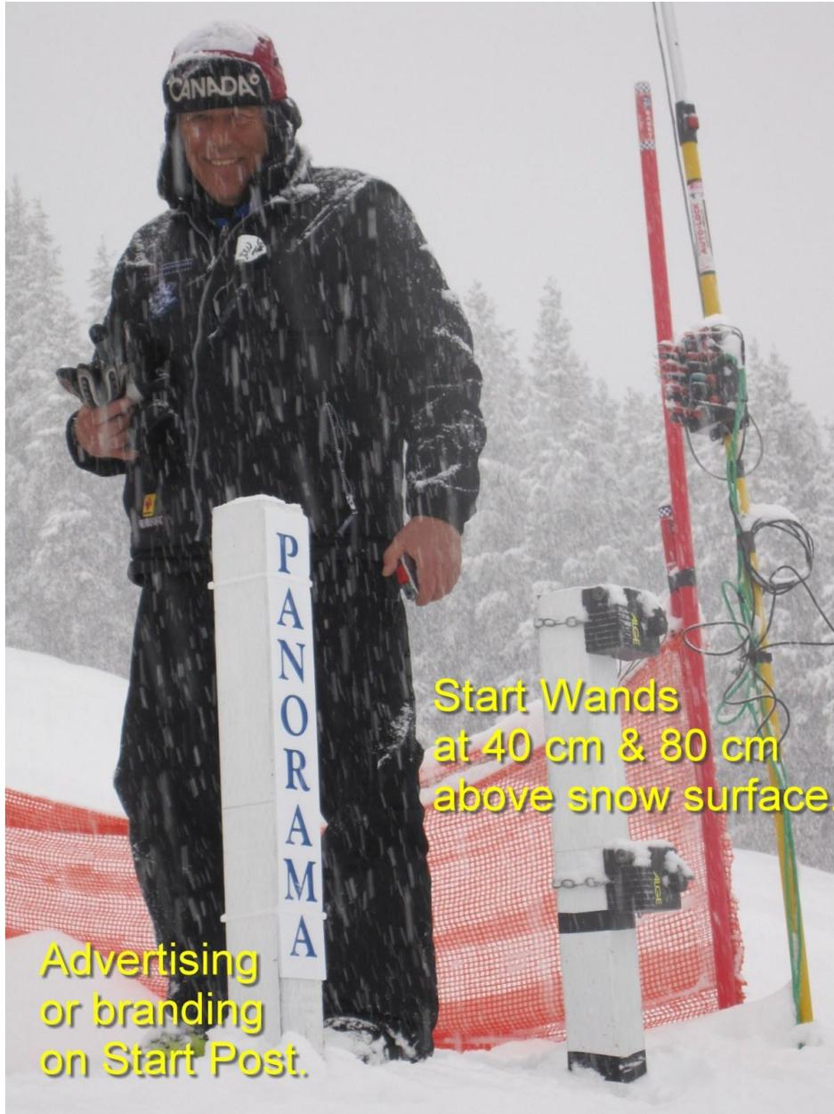
Les boîtiers des tiges de départ sont placés pour que la hauteur de la tige du départ se situe à 40 cm pour les skieurs debout et 80 cm pour les skieurs assis, et la tige est placée directement au-dessus du «<seuil de point de plus>>».
