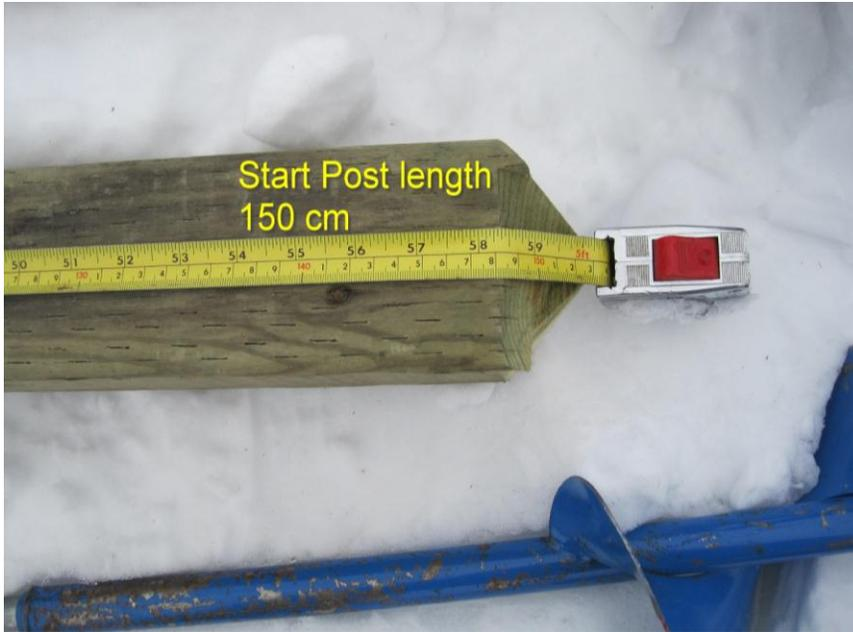
Le portillon de départ est formé de deux poteaux carrés de 150cm de long et 9 cm de large pour chaque côté. Le sommet du poteau doit être plat. Les 90 cm à partir du sommet doivent être peints en blanc. Les poteaux doivent être placés au sommet de la rampe de départ. La zone frontale des poteaux doit être à niveau. La piste débute du côté frontal (côté du parcours) des poteaux.
